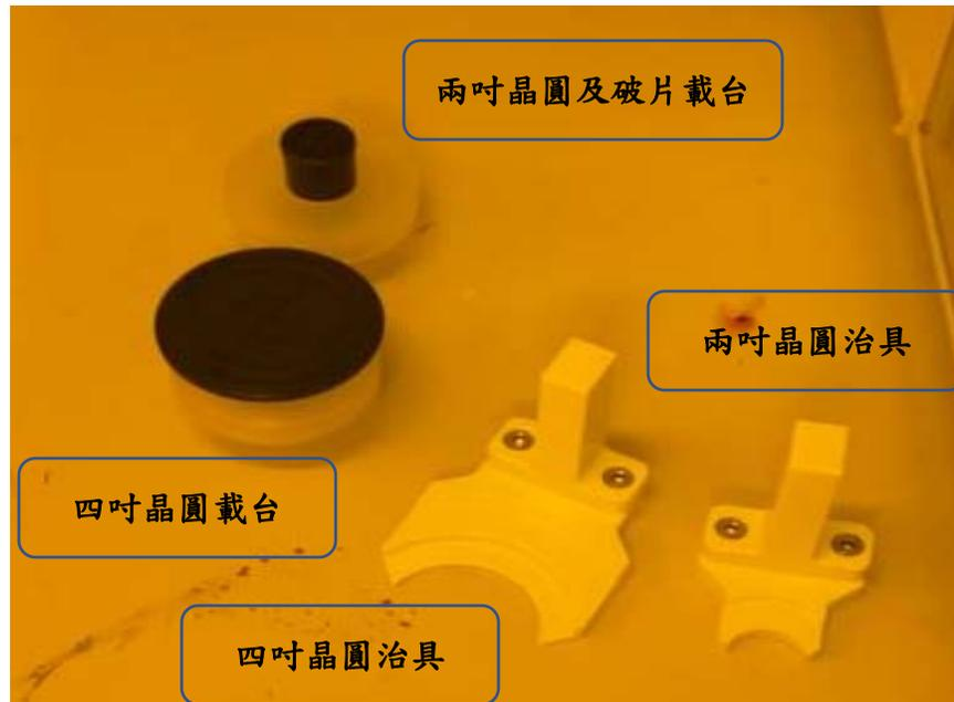
Figure 8 多段式 spin coater 治具及載臺
