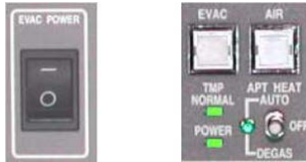
圖六 EVAC Power 開關、TMP NORMAL POWER 及 SC EVAC POWER 開關燈
