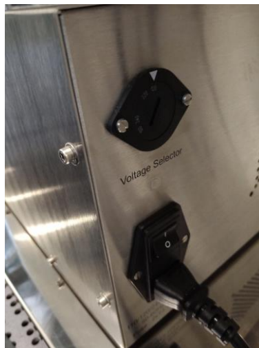
Figure 1 橢偏儀開關位於儀器後方，電腦主機下方
